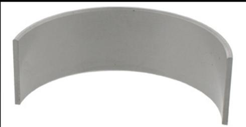
La bronzina alta / lato pistone, è riconoscibile come lato di spinta durante il ciclo di combustione, ed è soggetta al carico massimo, la sua composizione può variare, il materiale più comune utilizzato è LC/LCX, in quanto ha specifiche Heavy duty. Il colore del guscio superiore è generalmente bianco grigio opaco.
